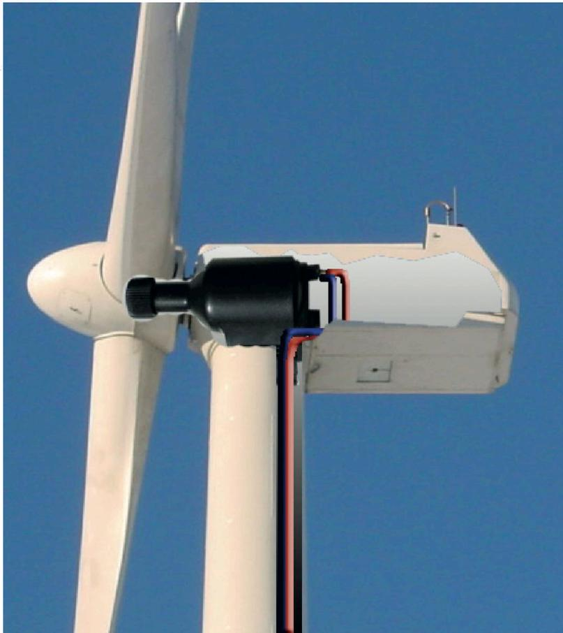
Der Wind dreht den Rotor. Die Energie des Windes wird in Drehenergie umgewandelt.
